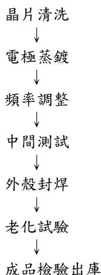
晶片經清洗後，置入真空蒸鍍機，依設計鍍上銀電極面，再用頻率調整機以鍍銀之銀量來達到設定之頻率，經過中間檢查後，以電焊接封合基座及外殼，經過標準老化實驗後，由自動檢測機依客戶需求之規格檢查，並經由品管部門確認後入庫。
